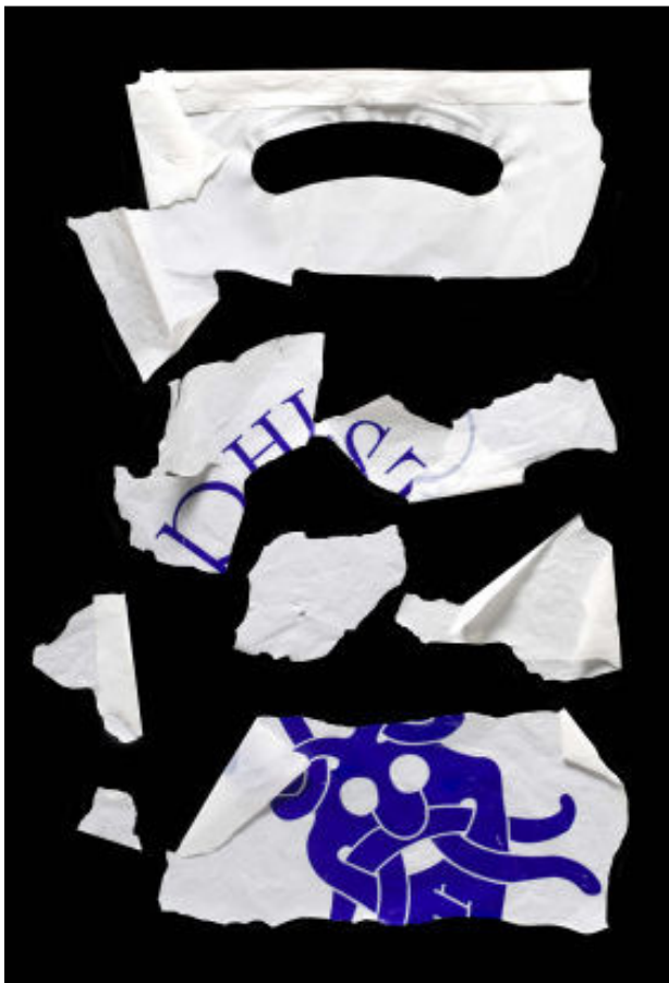
En polyethylen-bærepose er fragmenteret efter to års opbevaring i et mørkt rum på grund af påvirkning af luftens iltindhold.
